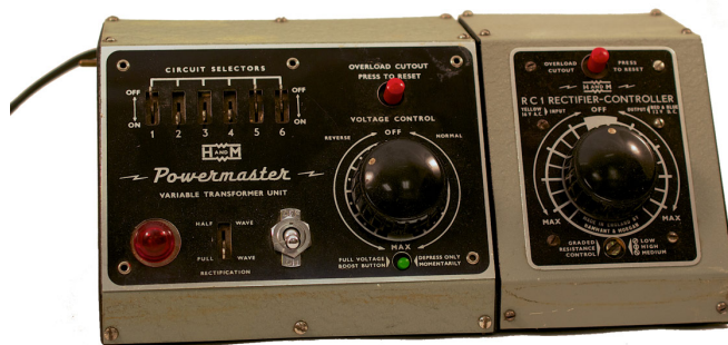
Obrázek 2.1: Analogový ovladač značky Hammant & Morgan schopný řízení až 5 vlaků. 1
