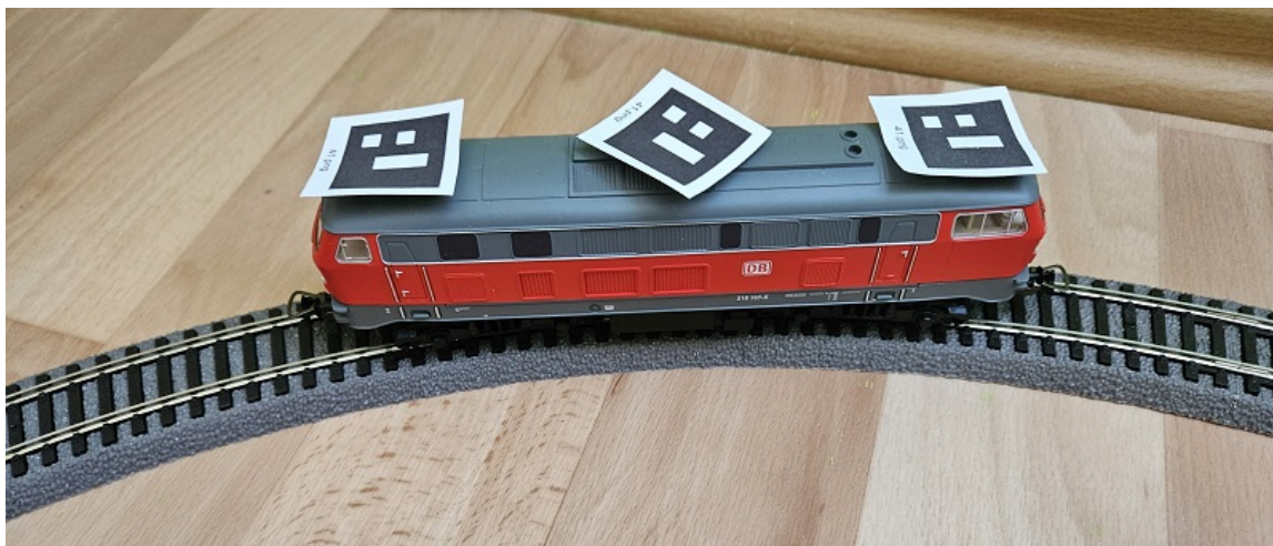
Obrázek 5.10: Umístění ArUco značky
