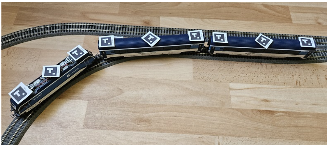
Obrázek 5.9: Umístění ArUco značky
