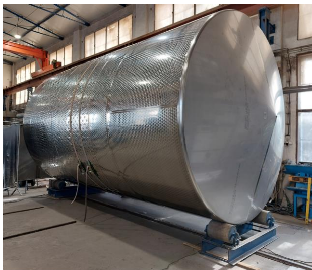
Obr. 11: Svařování pláště nádoby s objemem 50 tisíc litrů, foto J. Škrabal
