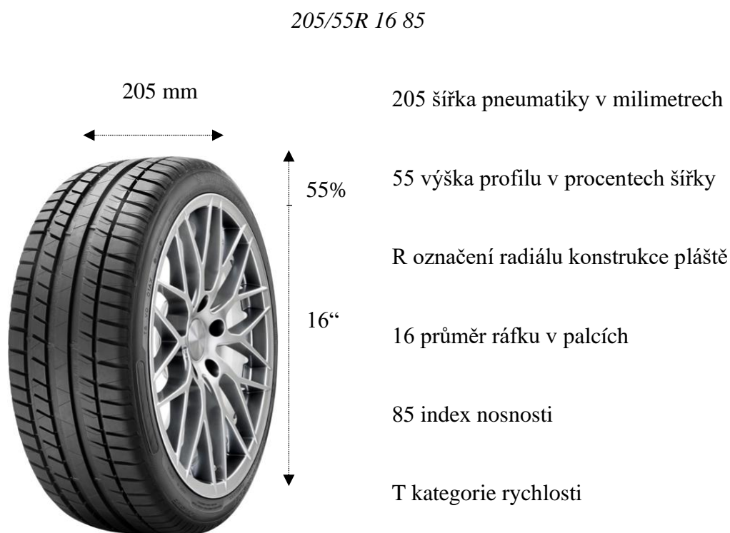
Obrázek č. 11: Rozměr pneumatik – zpracováno dle TASY 2021 [online]
