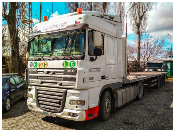
Obrázek 6-21 - DAF FT XF105.510 SSC s plošinovým návěsem Schmitz Cargobull AG SCS 24/L – 13,62 EB (zdroj: vlastní fotografie)
