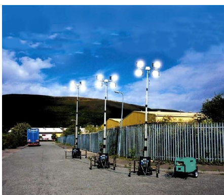
Obrázek 5-12 - Osvětlení staveniště, Zeppelin LINKTOWER (zdroj: https://zeppelin.cz/pujcovna )
