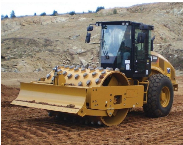
Obrázek 6-6 - Zeminový válec CAT CS66B (zdroj: zdroj: https://zeppelin.cz/cs/site/pujcovna )
