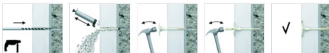
Obrázek 31: Postup montáže hmoždinky se zatlučovací trnem [84]
