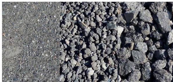
Obr. 15 – Asfaltový recyklát různých frakcí [48]
