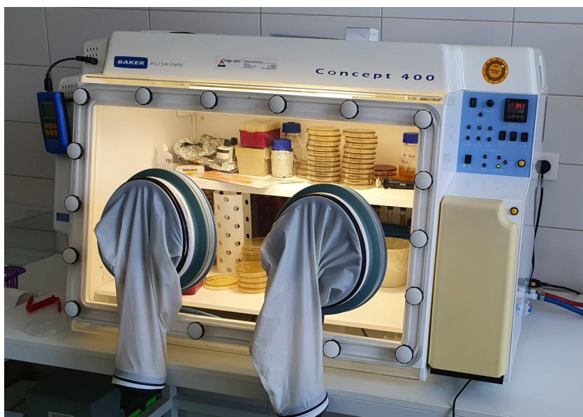
Obrázok 5: Box s udržovanou atmosférou 10% CO 2 ; 5% H 2 a 85% N 2 , teplotou 37°C a regulovanou vlhkosťou.
